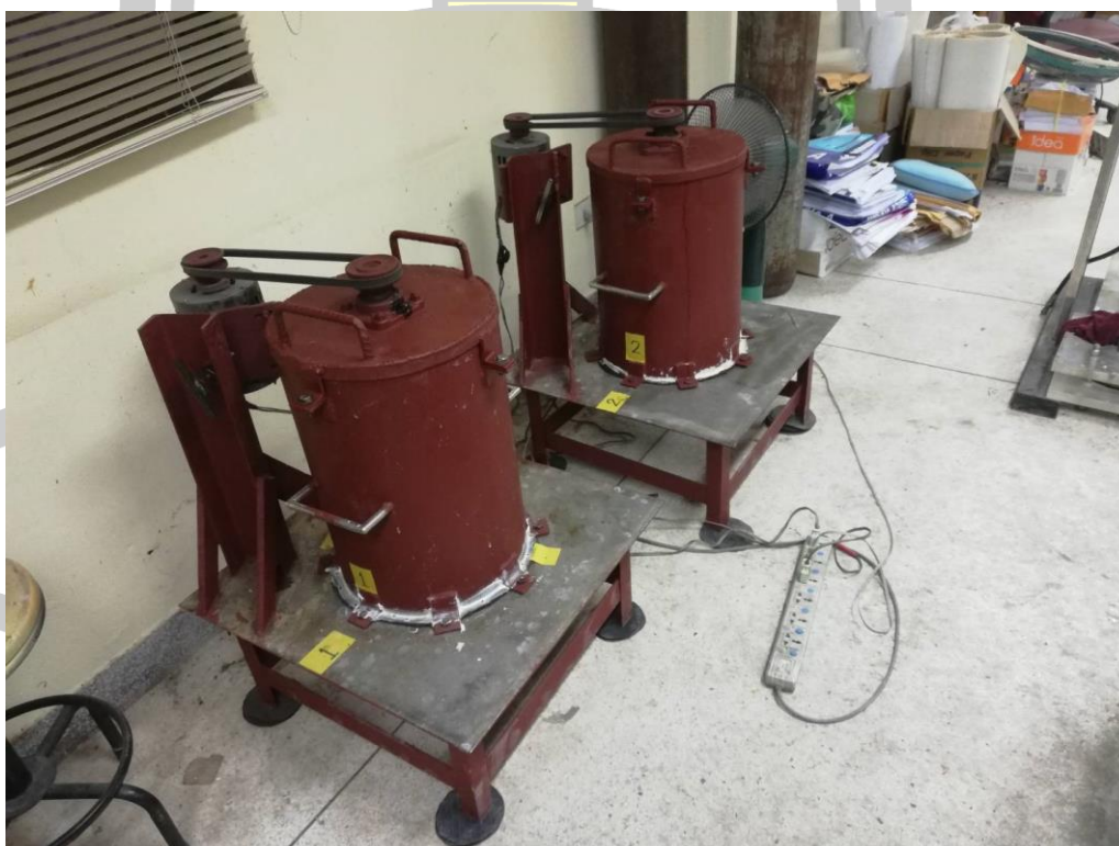
รูปที่ ข12 ทดสอบการสึกกร่อนอีโพอキシเรซินคอนกรีตเหลว
