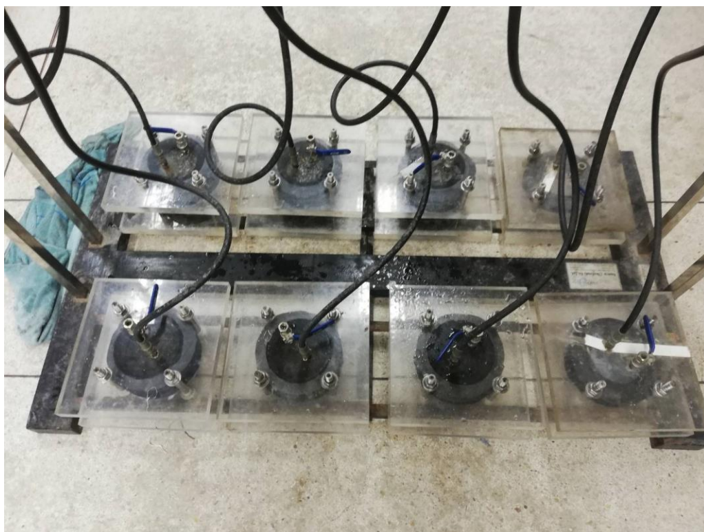
รูปที่ ข9 การติดตั้งตัวอย่างจีโอโพลิเมอร์คอนกรีตเก่าขานอ้อยสำหรับทดสอบการซึมผ่านน้ำ
