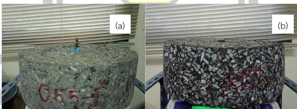
รูปที่ 45 การสึกกร่อนที่ปรากฏของคอนกรีตหลังการทดสอบ (a) คอนกรีตทั่วไป และ (b) จีโอโพลิเมอร์คอนกรีตเถ้าขานอ้อย
