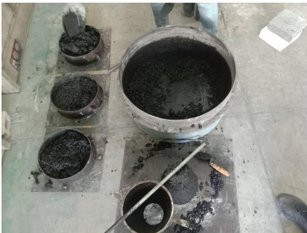
รูปที่ ข11 เตรียมตัวอย่างอีโพอキシเรซินคอนกรีตเหลวสำหรับทดสอบการสึกกร่อน
