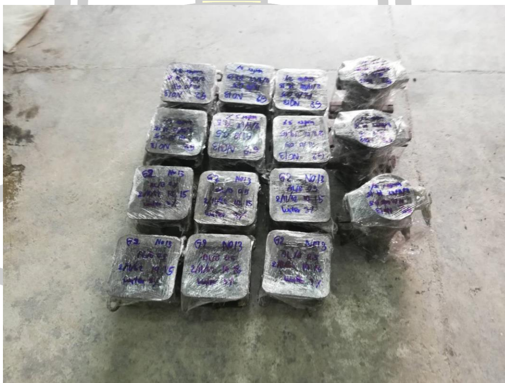
รูปที่ ข4 ตัวอย่างของจีโอโพลิเมอร์คอนกรีตแผ่นขานอ้อยก่อนบ่มร้อน
