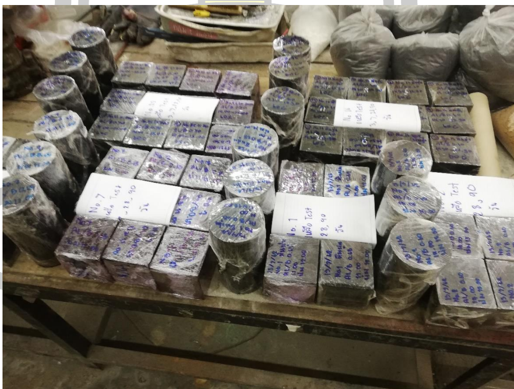
รูปที่ ๗6 ตัวอย่างของจีโอโพลิเมอร์คอนกรีตเก่าชานอ้อยบ่มในอุณหภูมิห้องจนถึงอายุการทดสอบ
