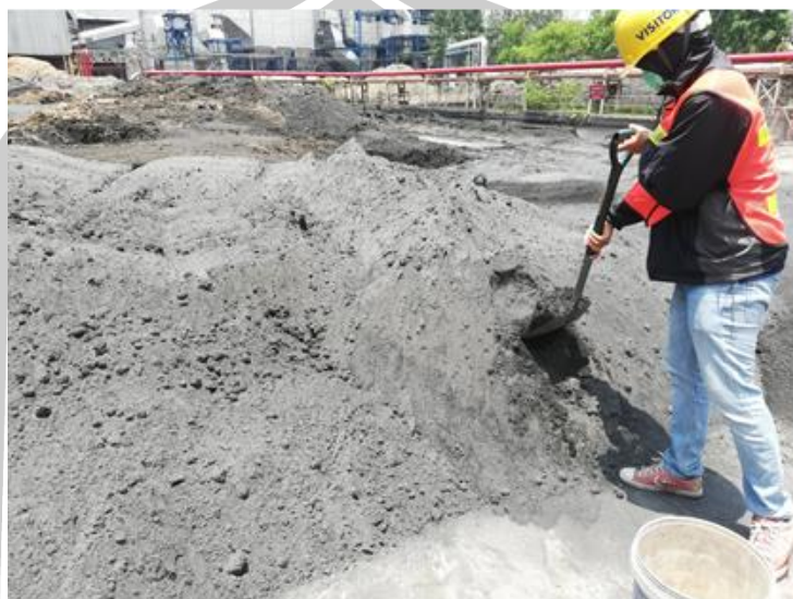
รูปที่ 2 กองเศษวัสดุเถ้าขานอ้อยที่เหลือทิ้งจากการผลิตไฟฟ้า
