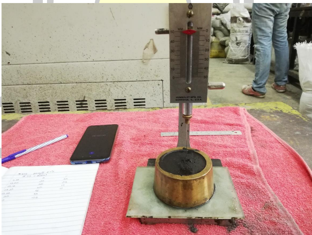
รูปที่ ข2 การทดสอบระยะเวลาการก่อตัวของจีโอโพลิเมอร์เพสต์เก่าชานอ้อย
