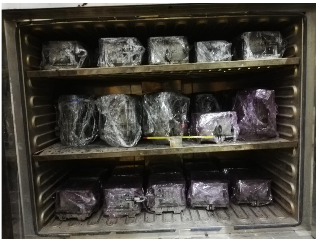
รูปที่ ๗5 ตัวอย่างของจีโอโพลิเมอร์คอนกรีตเก่าชานอ้อยบ่มร้อนในตู้อบไฟฟ้า
