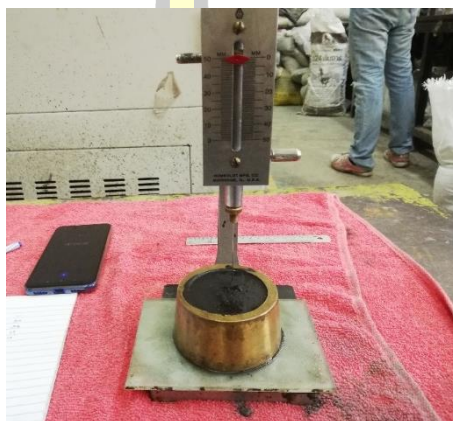
รูปที่ 18 การทดสอบระยะเวลาก่อตัวของจีโอโพลิเมอร์เพสต์
