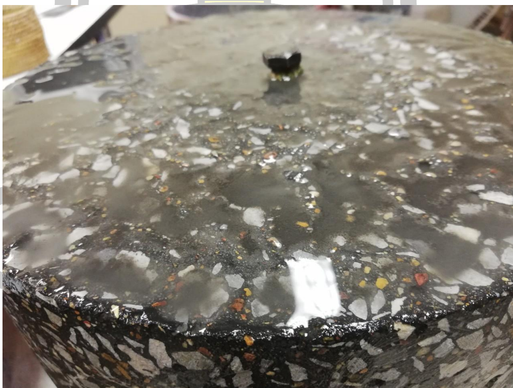
รูปที่ ข14 ลักษณะพื้นผิวการสีกร่อนของตัวอย่างจีโอโพลิเมอร์คอนกรีตเก้าขวานอ้อยหลังทดสอบ
