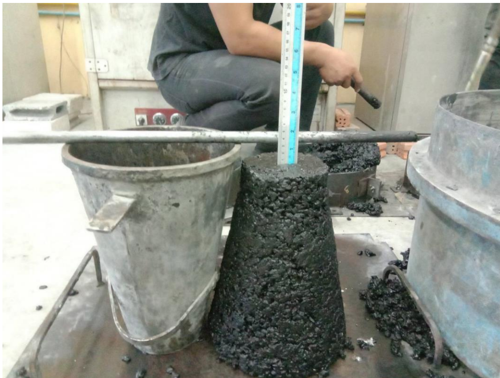
รูปที่ ข1 ค่าการยุบตัวของจีโอโพลิเมอร์คอนกรีตเก่าชานอ้อย
