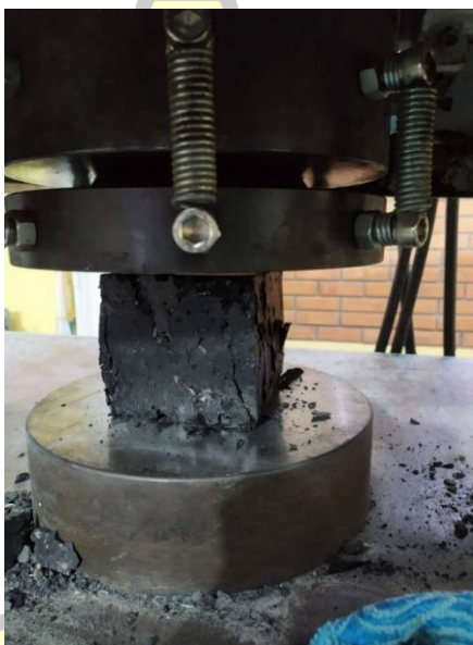
รูปที่ 12 การทดสอบกำลังอัดของจีโอโพลิเมอร์คอนกรีตด้วยเครื่องทดสอบ UTM
