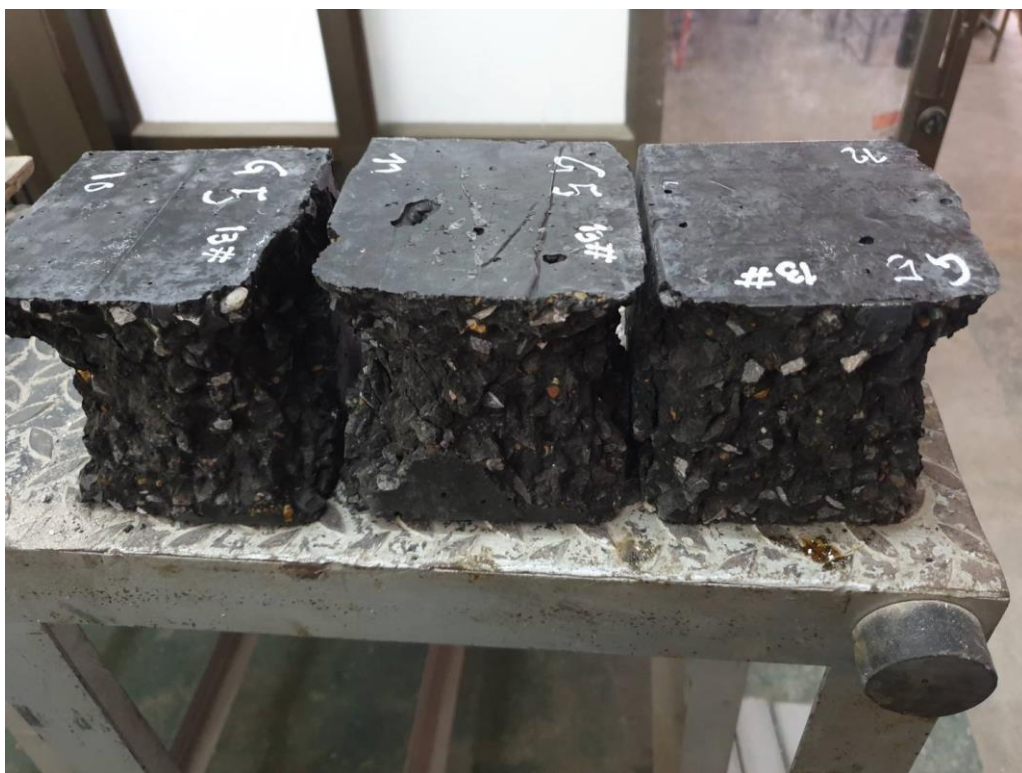
รูปที่ ข7 ลักษณะการพังเสียหายจากการทดสอบของจีโอโพลิเมอร์คอนกรีตเก่าชานอ้อย
