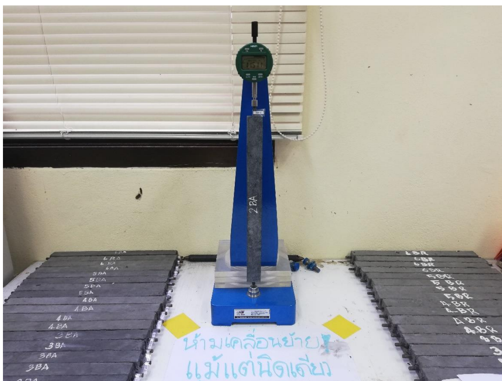
รูปที่ ข3 การทดสอบการหดตัวของเนื้อแข็งของจีโอโพลิเมอร์แผ่นขานอ้อยมอร์ตาร์
