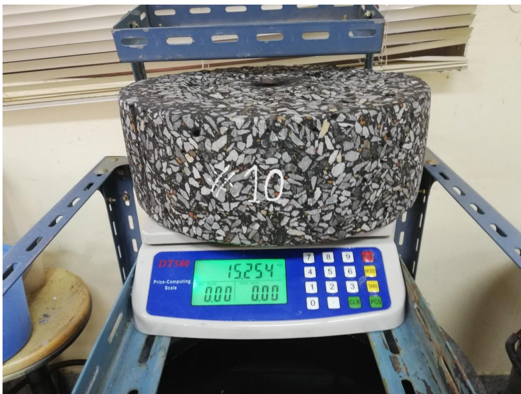
รูปที่ ข13 ชั่งน้ำหนักจีโอโพลิเมอร์คอนกรีตเก้าขวานอ้อยหลังการทดสอบแต่ละรอบ
