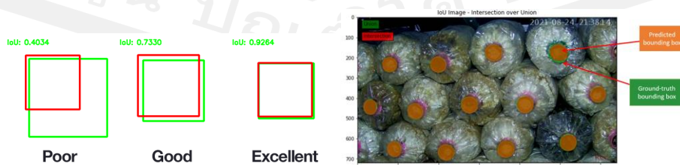
ภาพที่ 2.56 ตัวอย่างระดับการทับซ้อนของภาพ
