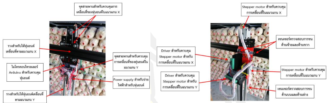
ส่วนประกอบชุดควบคุมการเคลื่อนที่ตามแนวแกน X แกน Y ด้านหน้า
