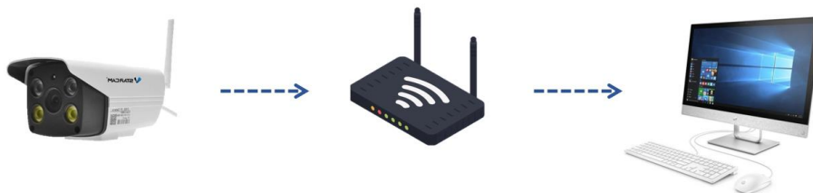
ภาพที่ 3.8 การส่งภาพถ่ายผ่าน IP กล้อง CCTV
