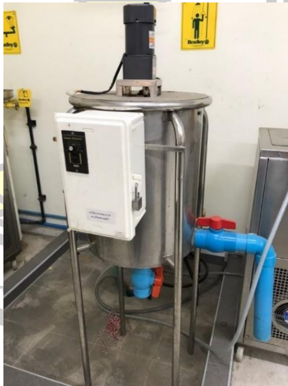
ภาพที่ 66 ตั้งอุปกรณ์สำหรับแยกเยื่อออกจากเปลือกไข่
