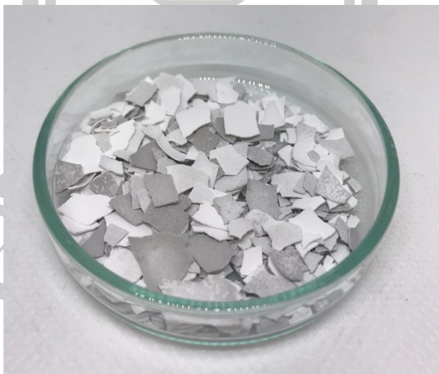
ภาพที่ 62 ลักษณะตัวอย่างเปลือกไข่ที่มีเชื้อเปลือกไข่หลังจากการเผาด้วยเตาเผาแบบหมุน
