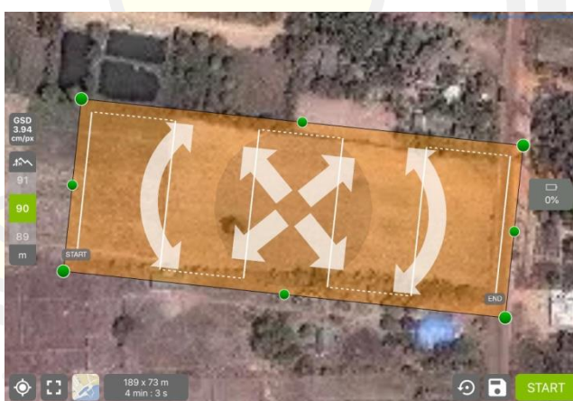
ภาพที่ 23 ความสูงและเวลาของการบิน ช่วง 30, 50 และ 90 เมตร
