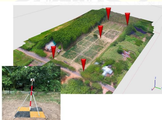
ภาพที่ 21 การรังวัดจุดควบคุมภาคพื้นดิน (GCPs) 5 จุด
