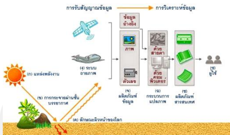
ภาพที่ 1 กระบวนการการสำรวจข้อมูลจากระยะไกล ที่มา : กิตติคุณ รุ่งเรือง (2556)
