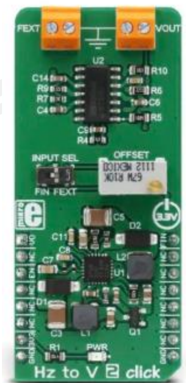
ภาพประกอบ Error! No text of specified style in document.54 วงจรแปลงความถี่เป็น แรงดัน รุ่น MIKROE-3126
