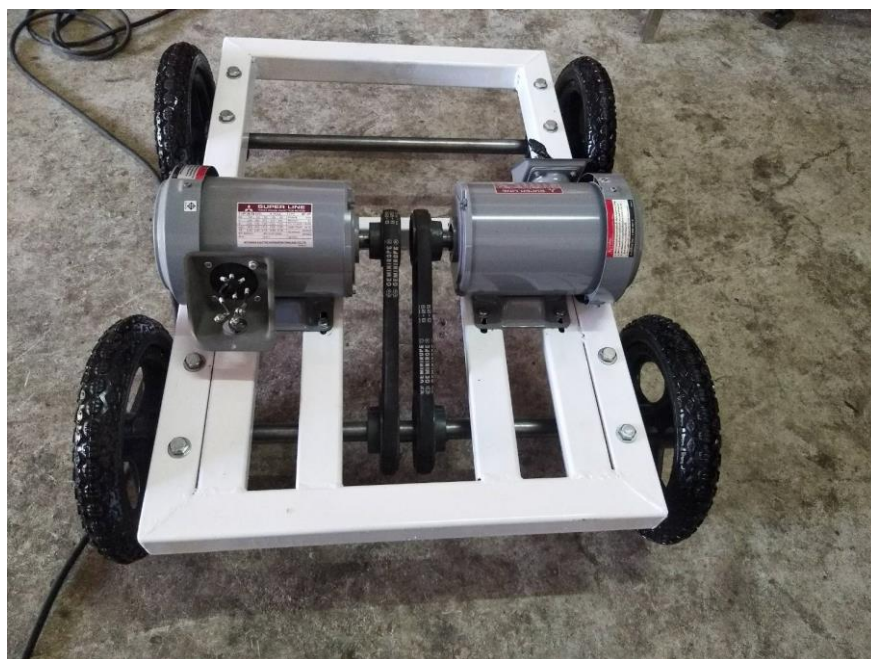
ภาพประกอบ Error! No text of specified style in document.76 ต้นแบบที่ใช้ในการศึกษา ระบบขับเคลื่อนมอเตอร์คู่
