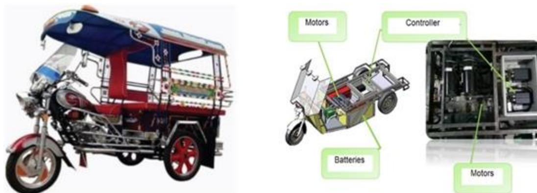
ภาพประกอบ Error! No text of specified style in document.29 โครงสร้างของระบบ ขับเคลื่อนแบบมอเตอร์คู่ [19]
