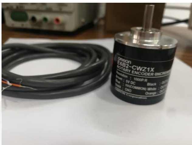
ภาพประกอบ Error! No text of specified style in document.52 เอ็นโคเดอร์ OMRON รุ่น E6B2-CWZ1X
