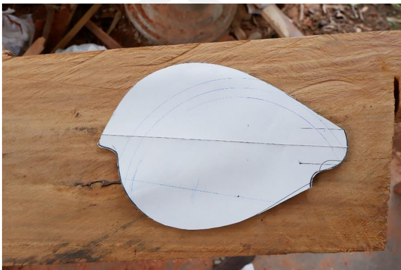
ภาพประกอบ 88 การวาดแบบตัวพินลงบนไม้ที่ใช้ในการทำพินต้นแบบ
