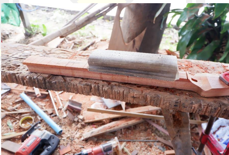
ภาพประกอบ 103 บล็อกฟิงเกอร์บอร์ดใช้สำหรับขัดฟิงเกอร์บอร์ด
