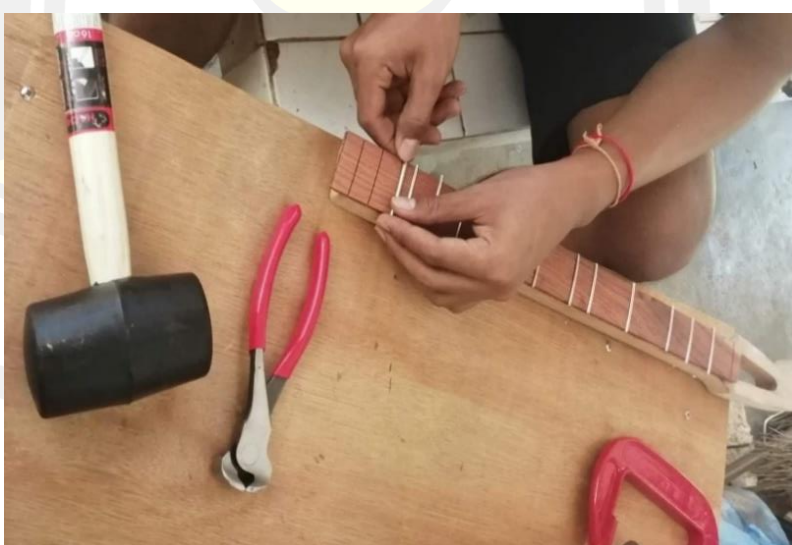
ภาพประกอบ 64 การติดเฟรตพืนของว่าที่ร้อยตรีวิจิตร บุญมี
