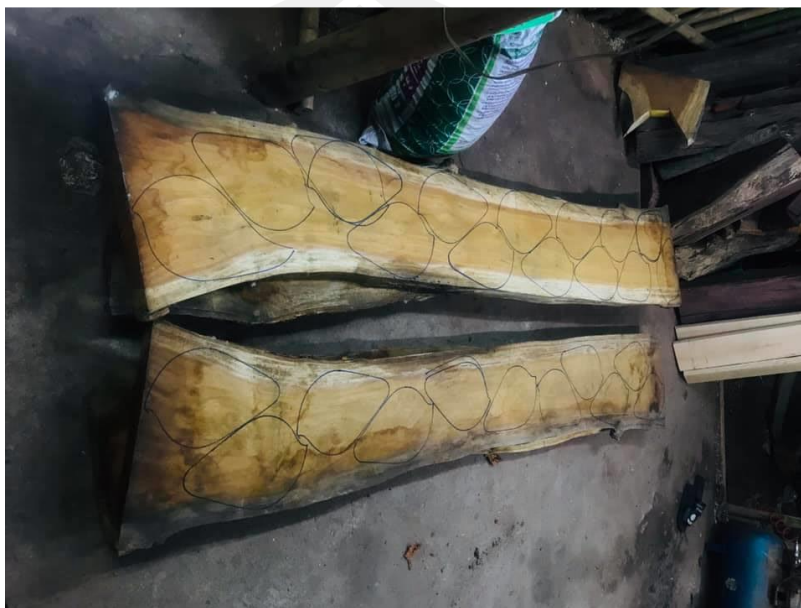
ภาพประกอบ 56 การวาดแบบพินลงบนไม้ที่ใช้ทำพินของว่าที่ร้อยตรีวิจิตร บุญมี
