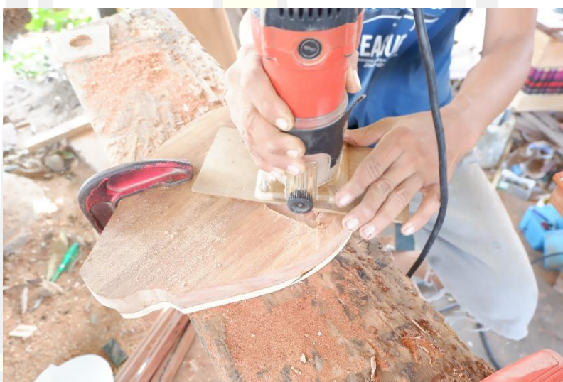
ภาพประกอบ 98 การชุดเจาะร่องสำหรับใส่คอพินตามบล็อกหรือแม่พิมพ์
