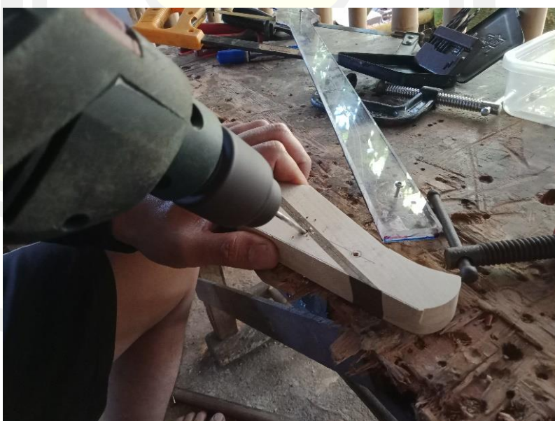
ภาพประกอบ 62 การเจาะรูใส่ลูกบิดพิณของว่าที่ร้อยตรีวิจิตร บุญมี
