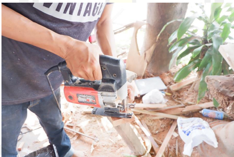
ภาพประกอบ 92 ตัดคอปืนตามรูปแบบ
