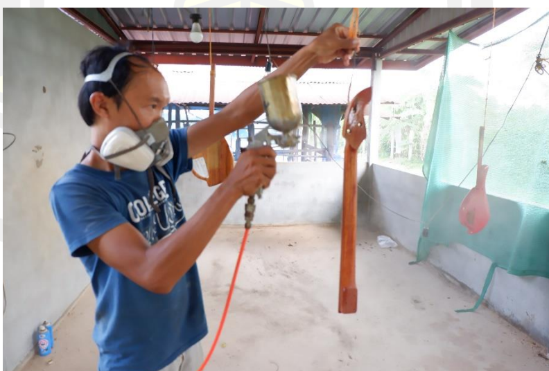
ภาพประกอบ 114 การพ่นสีรองพื้นคอพิณของพิณต้นแบบ
