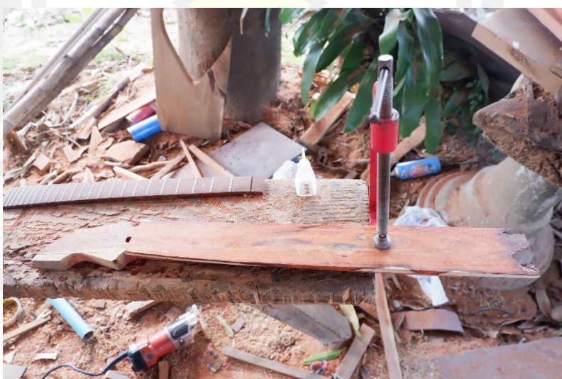
ภาพประกอบ 101 การติดฟิงเกอร์บอร์ดเข้ากับส่วนคอของพิน
