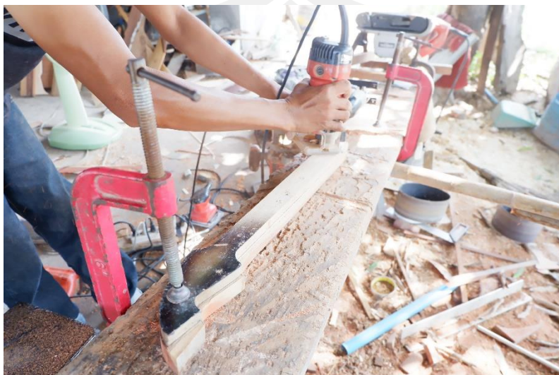
ภาพประกอบ 93 การตกแต่งรูปแบบของพินด้วยทริมเมอร์หรือเรเตอร์
