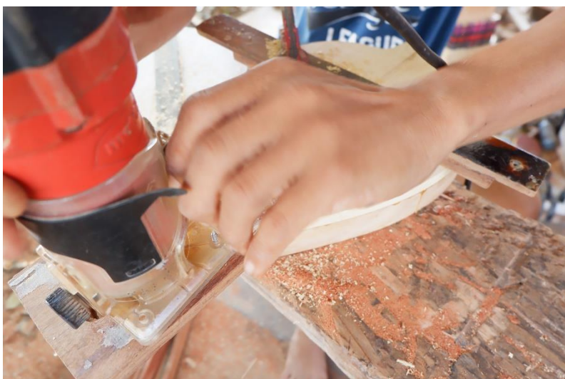
ภาพประกอบ 98 การชุดเจาะร่องสำหรับใส่คอพินตามบล็อกหรือแม่พิมพ์
