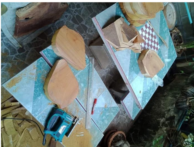
ภาพประกอบ 57 การใช้เลื่อยตัดโครงพินตามรูปแบบที่วาดไว้
