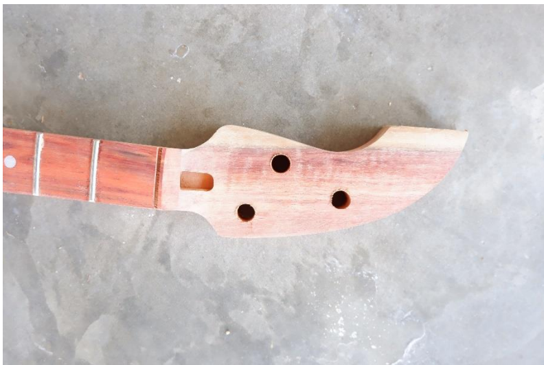
ภาพประกอบ 108 เจาะรูสำหรับใส่ลูกบิดของพินตันแบบ
