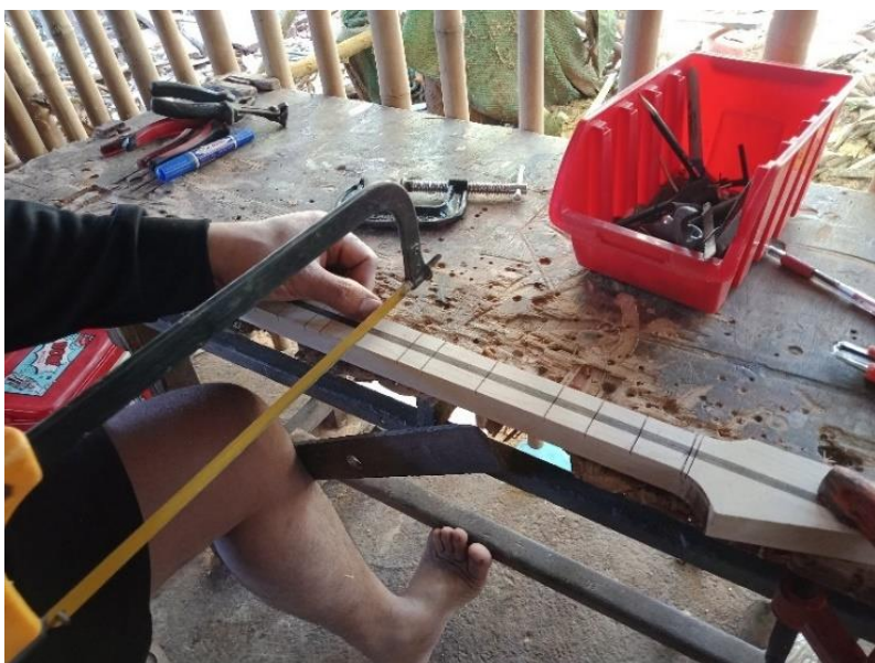
ภาพประกอบ 61 การเลื่อยร่องเฟรตของว่าที่ร้อยตรีวิจิตร บุญมี
