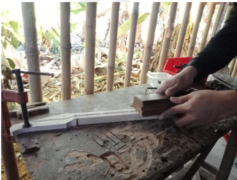
ภาพประกอบ 63 การใช้บล็อกฟิงเกอร์บอร์ดขัดคอปืนของว่าที่ร้อยตรีวิจิตร บุญมี
