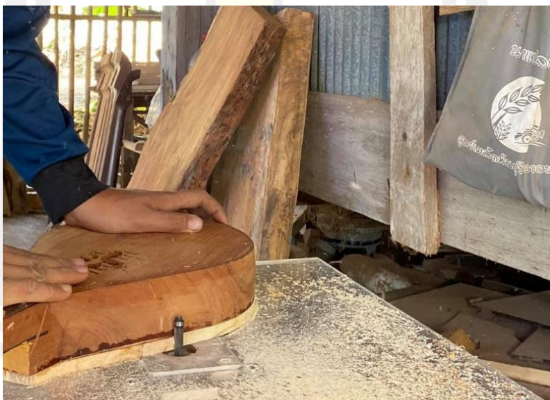
ภาพประกอบ 59 การเก็บงานด้วยเรเตอร์ของว่าที่ร้อยตรีวิจิตร บุญมี
