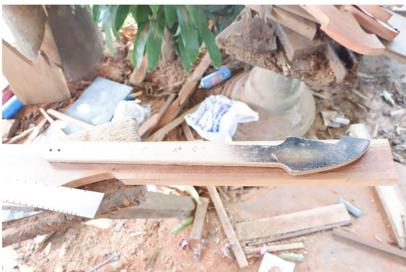
ภาพประกอบ 89 การวาดแบบคอปิลงบนไม้ที่ใช้ทำพินต้นแบบ
