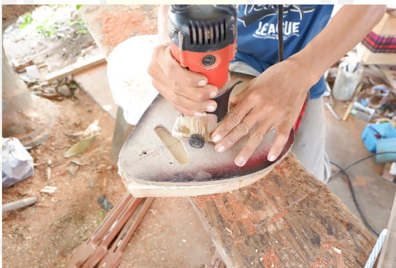
ภาพประกอบ 97 การขุดเจาะร่องสำหรับใส่คอนแทรกตามบล็อกหรือแม่พิมพ์
