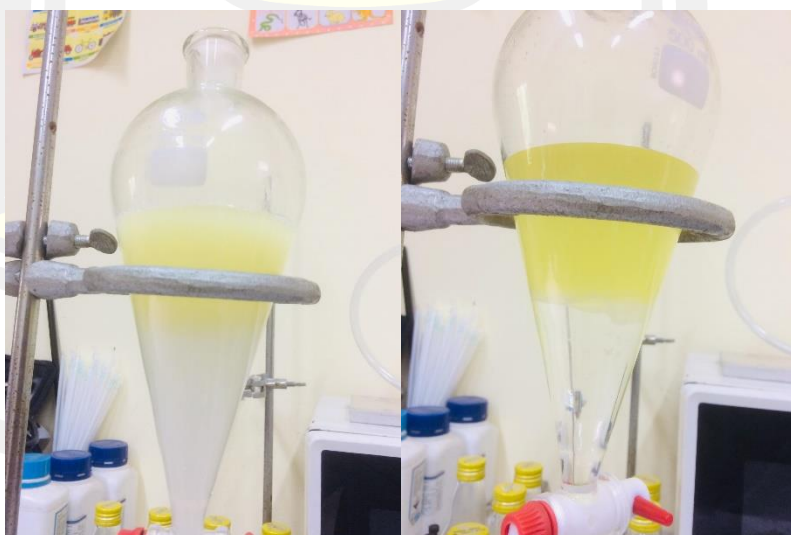
ภาพประกอบ ค.20 นำไบโอดีเซลที่ได้จากการทรานเอสเทอร์ฟิเคชันมาล้างน้ำด้วยน้ำกลั่นบริสุทธิ์ในปริมาณที่เหมาะสมแล้วนำไปอุ่นเพื่อเอาน้ำที่ตกค้างออกจากรันน้ำมัน
