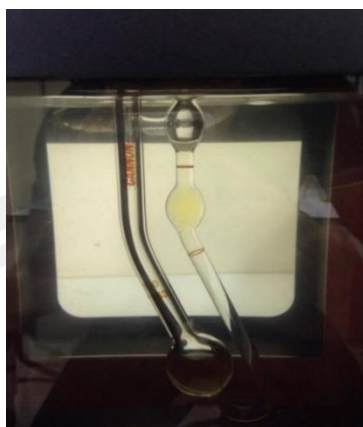
ภาพประกอบ 3.3 เครื่องวัดค่าความหนืด Size 150
