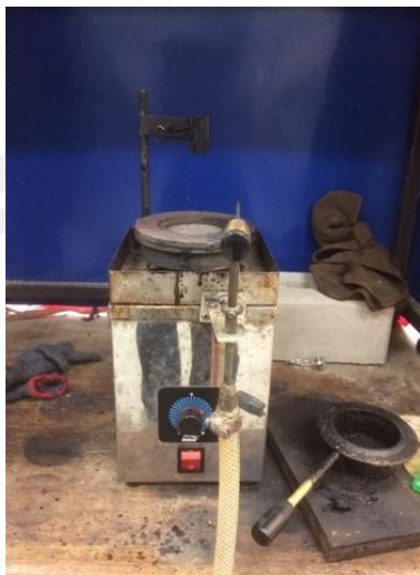
ภาพประกอบ ค.23 เครื่องวัดค่าจุดติดไฟ
