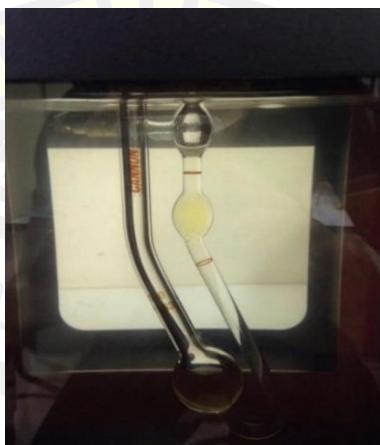
ภาพประกอบ ค.24 เครื่องวัดค่าความหนืด Size 150
