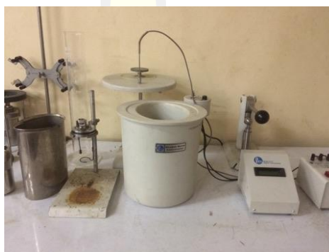
ภาพประกอบ 3.2 เครื่องวัดค่าความร้อน
