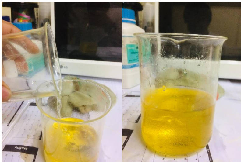
ภาพประกอบ ค.17 เทส่วนผสมเมทานอลและโพแทสเซียมลงในน้ำมันปาล์ม (ROL) ที่อุ่นในอุณหภูมิ 60 องศาเซลเซียสและ 80 องศาเซลเซียส
