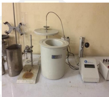
ภาพประกอบ ค.22 เครื่องวัดค่าความร้อน
