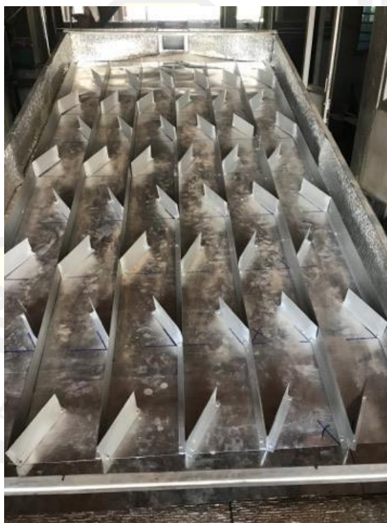
ภาพประกอบ 3.3 การติดตั้งครีบบายความร้อน
