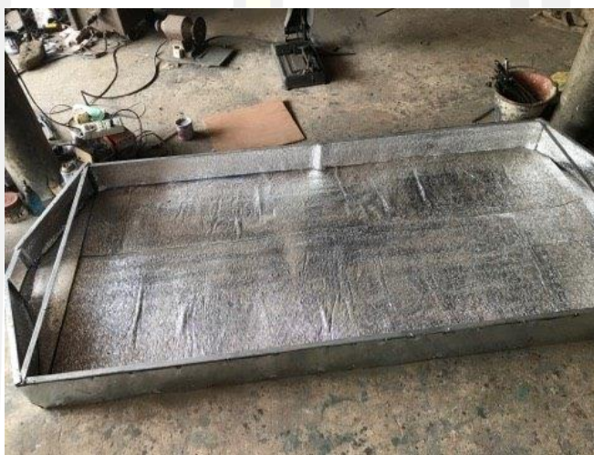
ภาพประกอบ 3.1 หุ้มฉนวนกันความร้อนตัวเก็บรังสีดวงอาทิตย์
