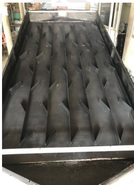
ภาพประกอบ 3.4 รังสีอาทิตย์ทำด้วยสีดำด้าน
