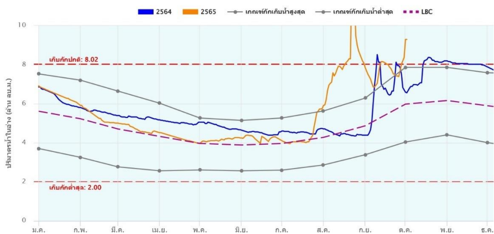
ภาพที่ 11 รายละเอียดโค้งควบคุมของอ่างเก็บน้ำแก่งเลิงจาน ที่มา : โครงการชลประทานจังหวัดมหาสารคาม (2565)
