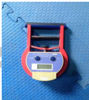
ภาพประกอบ 65 เครื่องวัดแรงบีบมือ (Hand Grip Dynamometer)
