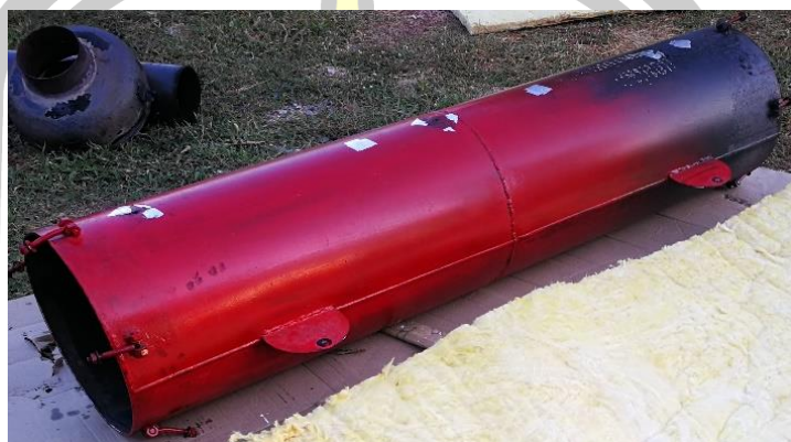
ภาพประกอบ 28 ห้องเผาไหม้ดัดแปลงจากถังขนาด 48 ลิตร
