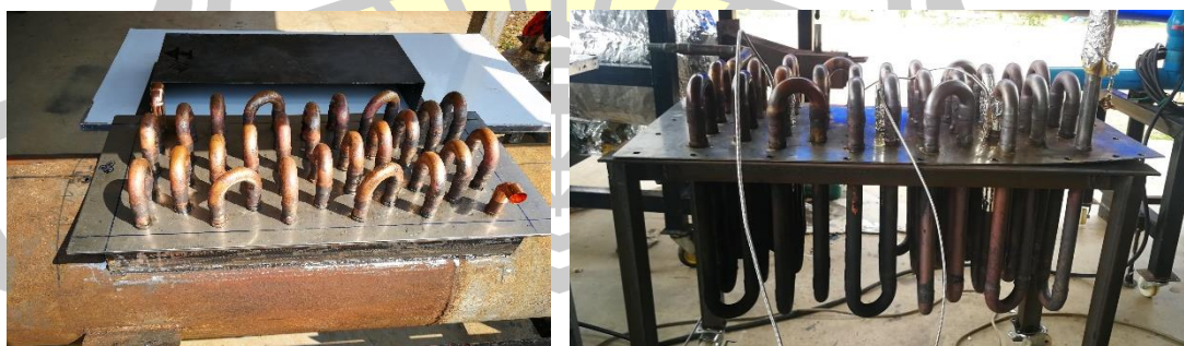
ภาพประกอบ 29 ชุดทดลองท่อแลกเปลี่ยนความร้อน
