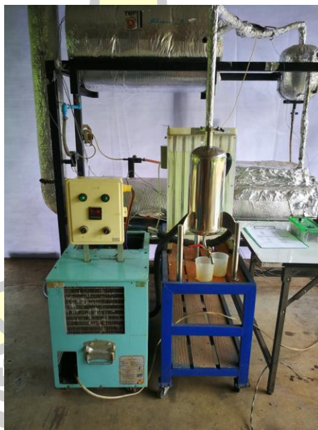
ภาพประกอบ 36 ชุดอ่างทำความเย็นสำหรับควบแน่น
