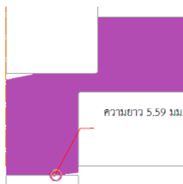
ข) ลักษณะขนาดความยาวของอัดขึ้นรูปที่แรงดัน Counter Punch 40000
