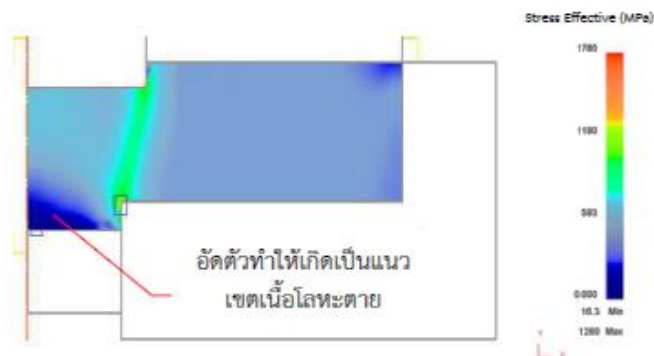
ค) ลักษณะการเกิดความเค้นขณะที่วัสดุเคลื่อนไหลตัว Counter Punch 60000
