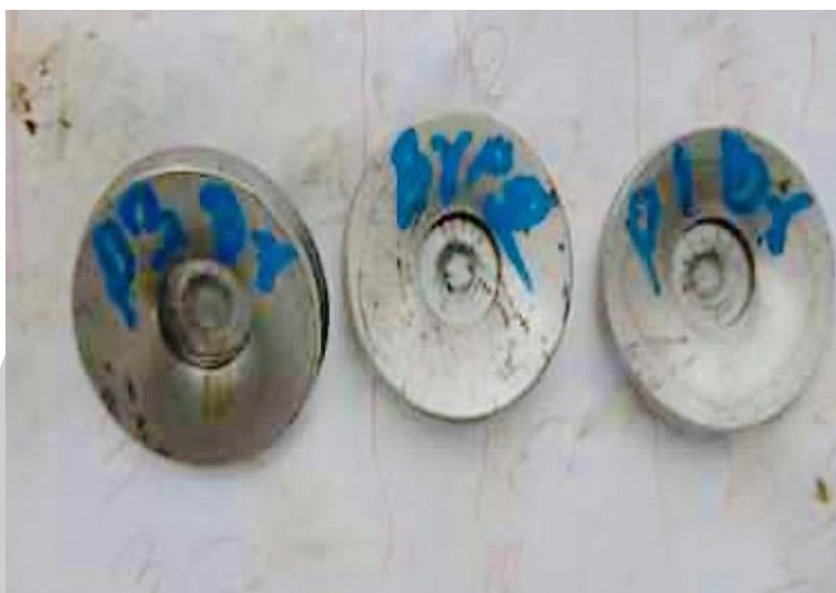
ภาพประกอบ 1 แสดงการยู่บตัวชิ้นงานทดสอบแรงเสียดทานด้วยแม่พิมพ์อัดขึ้นรูปโลหะ
