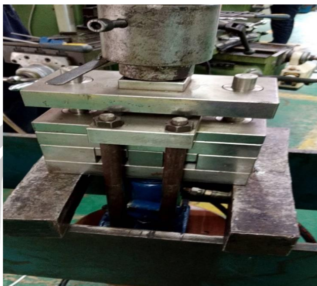
ภาพประกอบ 62 แสดงแม่พิมพ์อัดขึ้นรูปโลหะแผ่นที่สร้างสำหรับการทดลอง
