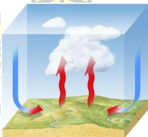
ภาพที่ 6 การจำลองการยกเนื่องจากความร้อน
